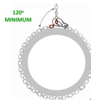
Rys. 4. Minimalny kąt zagięcia cięgna przy obwiązywaniu elementu
